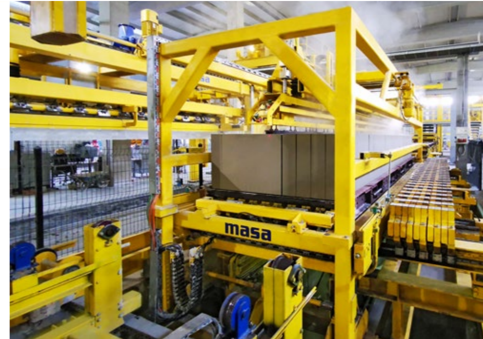
Mesa de separación en crudo con las barras de separación dispuestas según el producto
