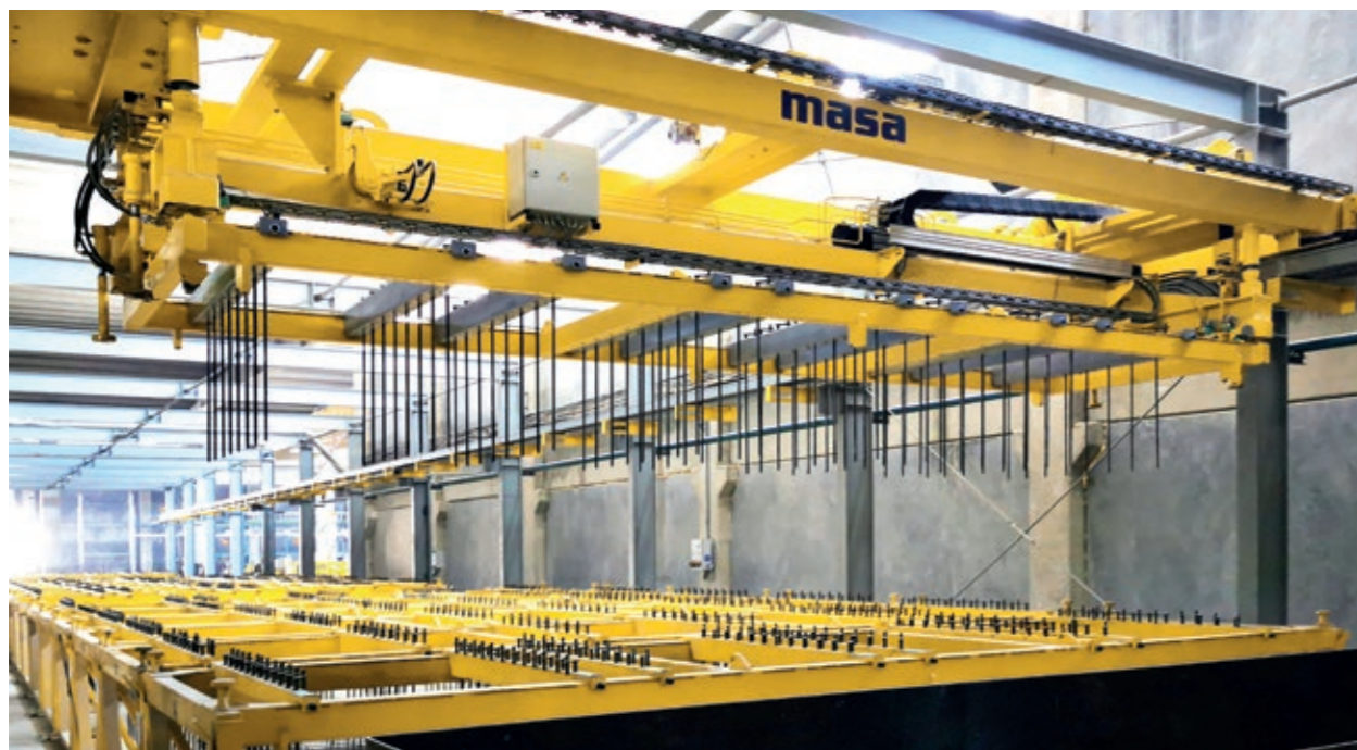
Preparación de la armadura
