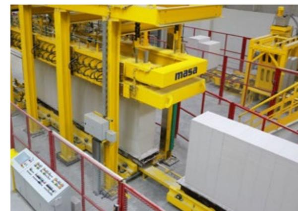
Como alternativa, ofrecemos un segundo método para el proceso de separación: la máquina separadora para productos ya tratados en autoclave. Por supuesto, le asesoraremos sobre la variante recomendada para sus necesidades.
