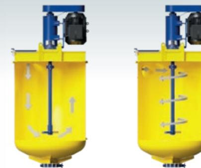
Representación esquemática: diferentes direcciones de flujo para la introducción vertical (izq.) y tangencial (der.) de los componentes líquidos.
