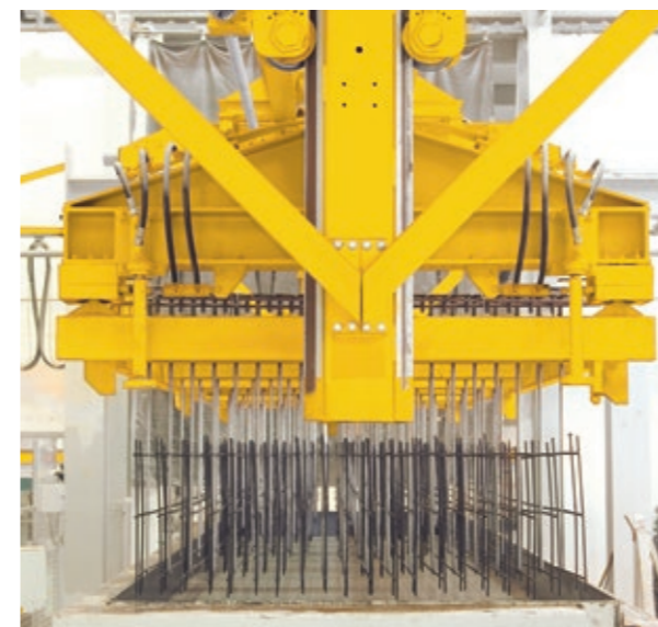
Inserción de armadura
