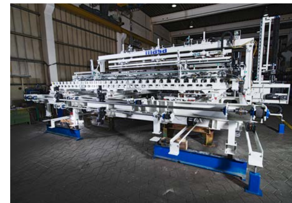
Made in Germany: stół do separacji świeżych elementów krótko przed wysyłką z zakładu w Porta Westfalica.
