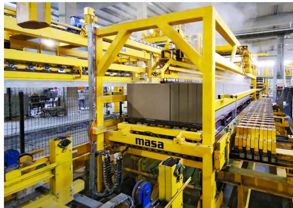
Stół do separacji świeżych elementów z regulacją belek rozdzielających dostosowaną do danego produktu
