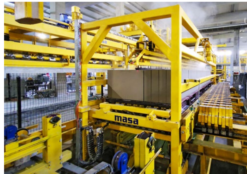
Grüntrenntisch mit produktbezogener Anordnung der Trennbalken
