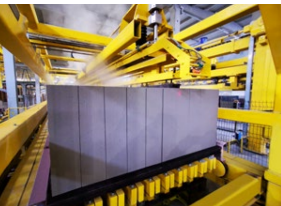
Trennprozess der Produkte im grünen Zustand
