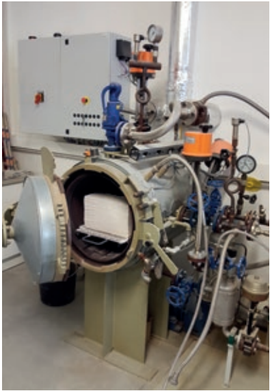
Laboreinrichtung zur Qualifizierung der kundenseitigen Rohstoffe und Simulation des Fertigungsprozesses
