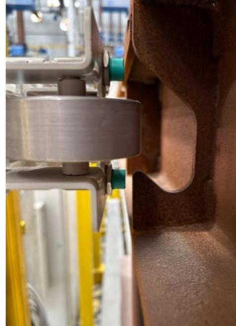
Считывающее устройство для двоичного кодирования на запорочной решетке
