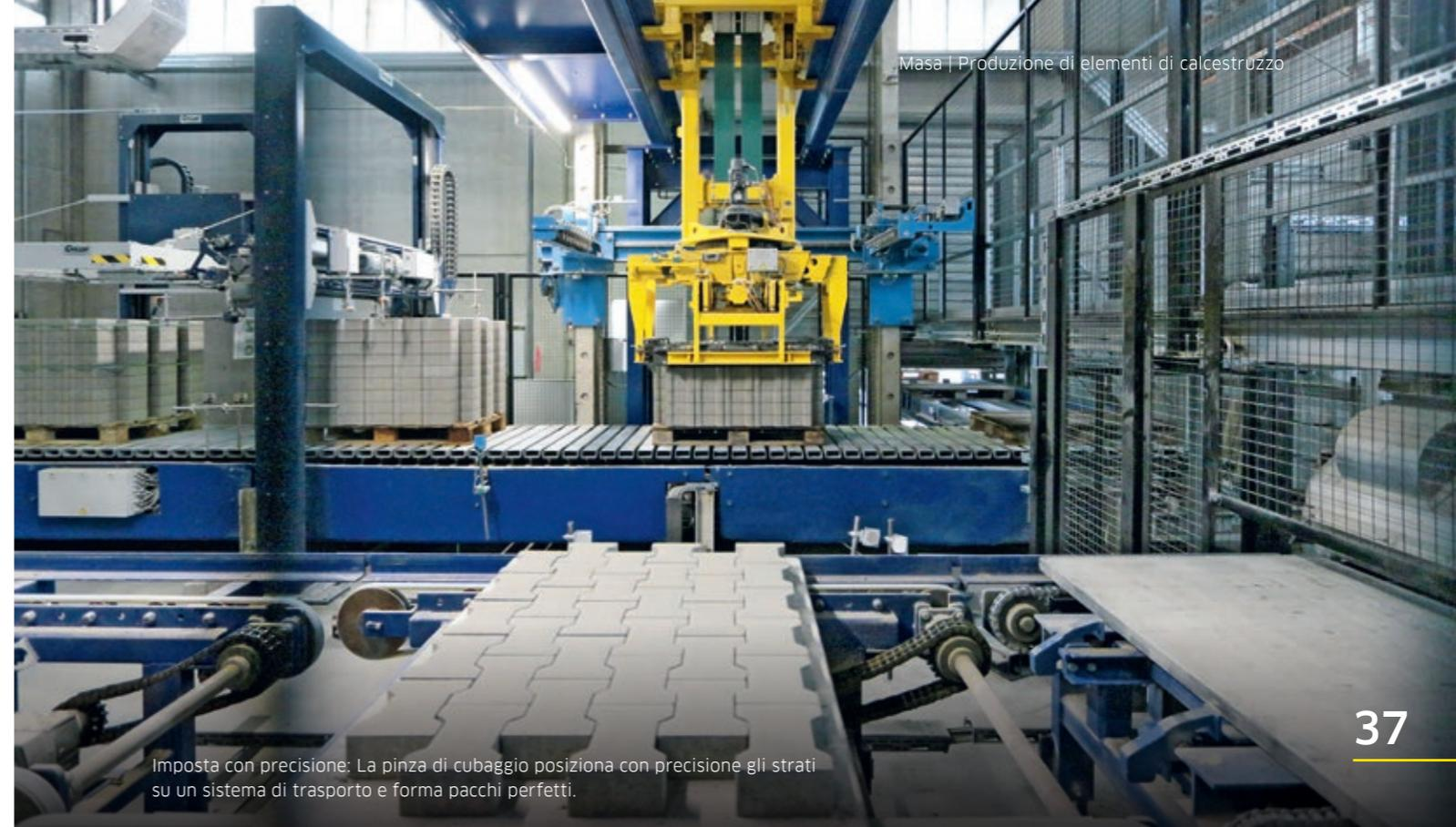
Imposta con precisione: La pinza di cubaggio posiziona con precisione gli strati su un sistema di trasporto e forma pacchi perfetti.
