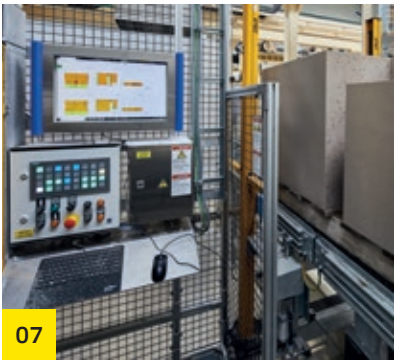
Umsetzmanipulator II Umsetzen der fertigen Pass-Steine auf Transportpaletten.
