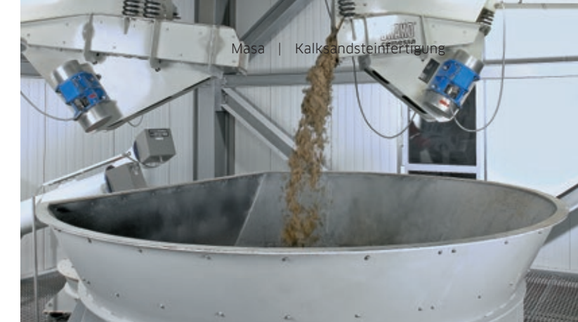
Komponente zur exakten Dosierung der Sandmenge
