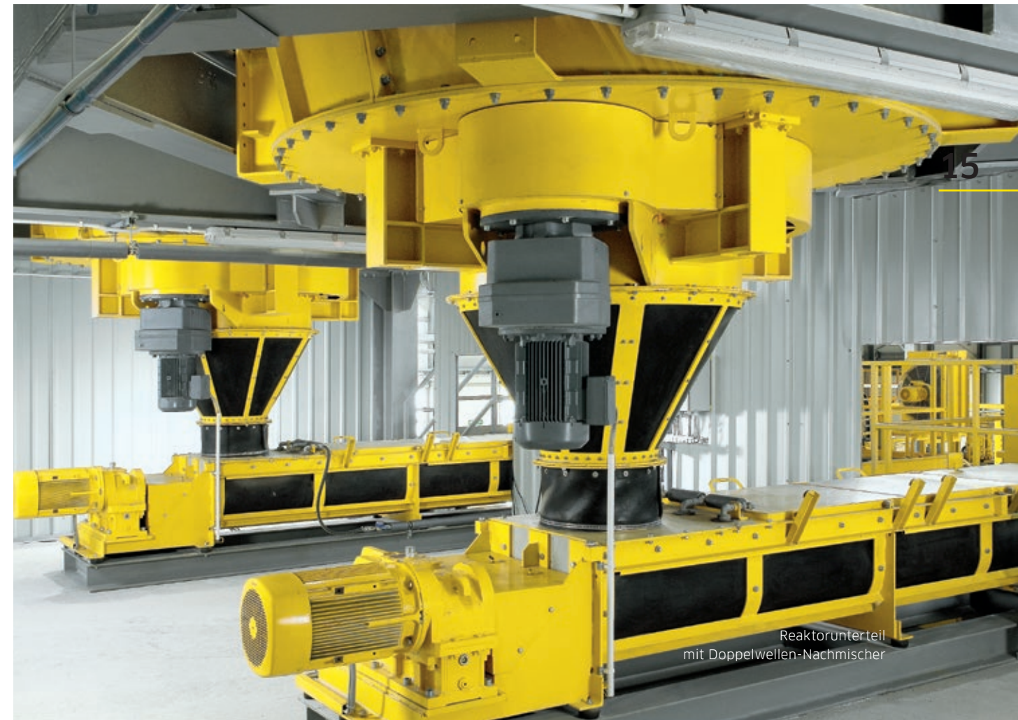
Intensivmischer für ein homogenes Ausgangsprodukt
