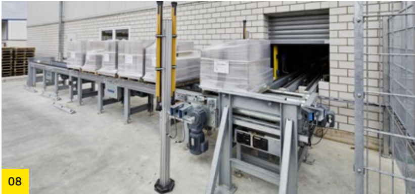
Abnahmestation Vorkonfektionierte Pass-Stein-Pakete zur Auslieferung auf die Baustelle.
