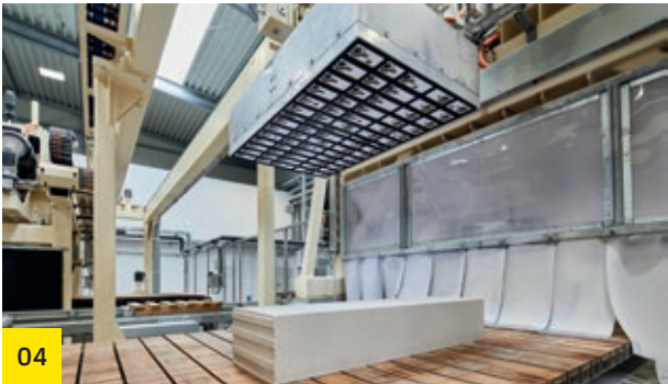
Vakuumplatte Durch die Aufteilung in Vakuumkammern können individuelle Pass-Stein-Größen umgesetzt werden.
