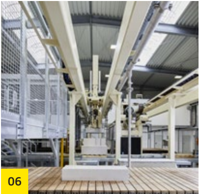
Umsetzmanipulator II Umsetzen der fertigen Pass-Steine auf Transportpaletten.
