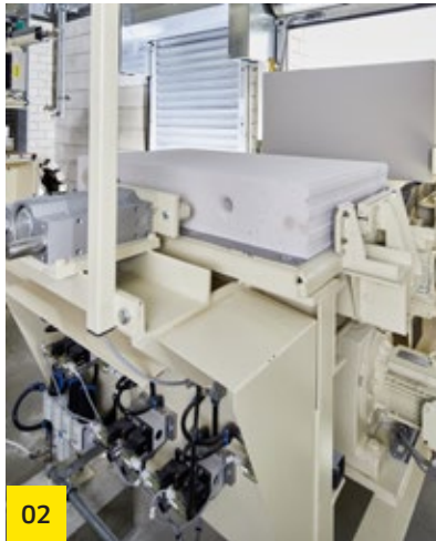
Übergabestation Zentrierung der Planelemente und exakt ausgerichtete Übergabe an den Umsetz- manipulator I.
