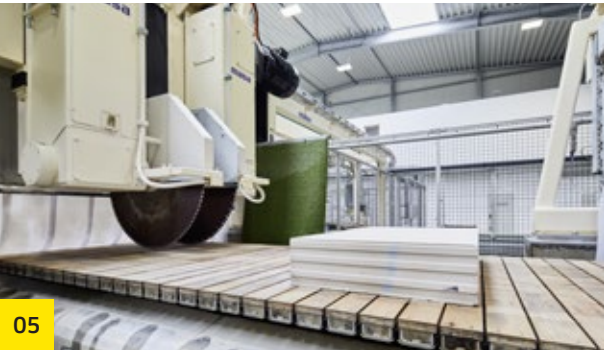
Sägeportal II Herstellung von speziellen Geometrien wie Giebel- und Gehrungs- schnitte.
