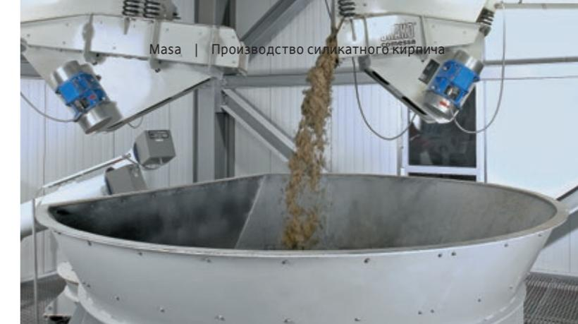
Компоненты для точного дозирования песка
