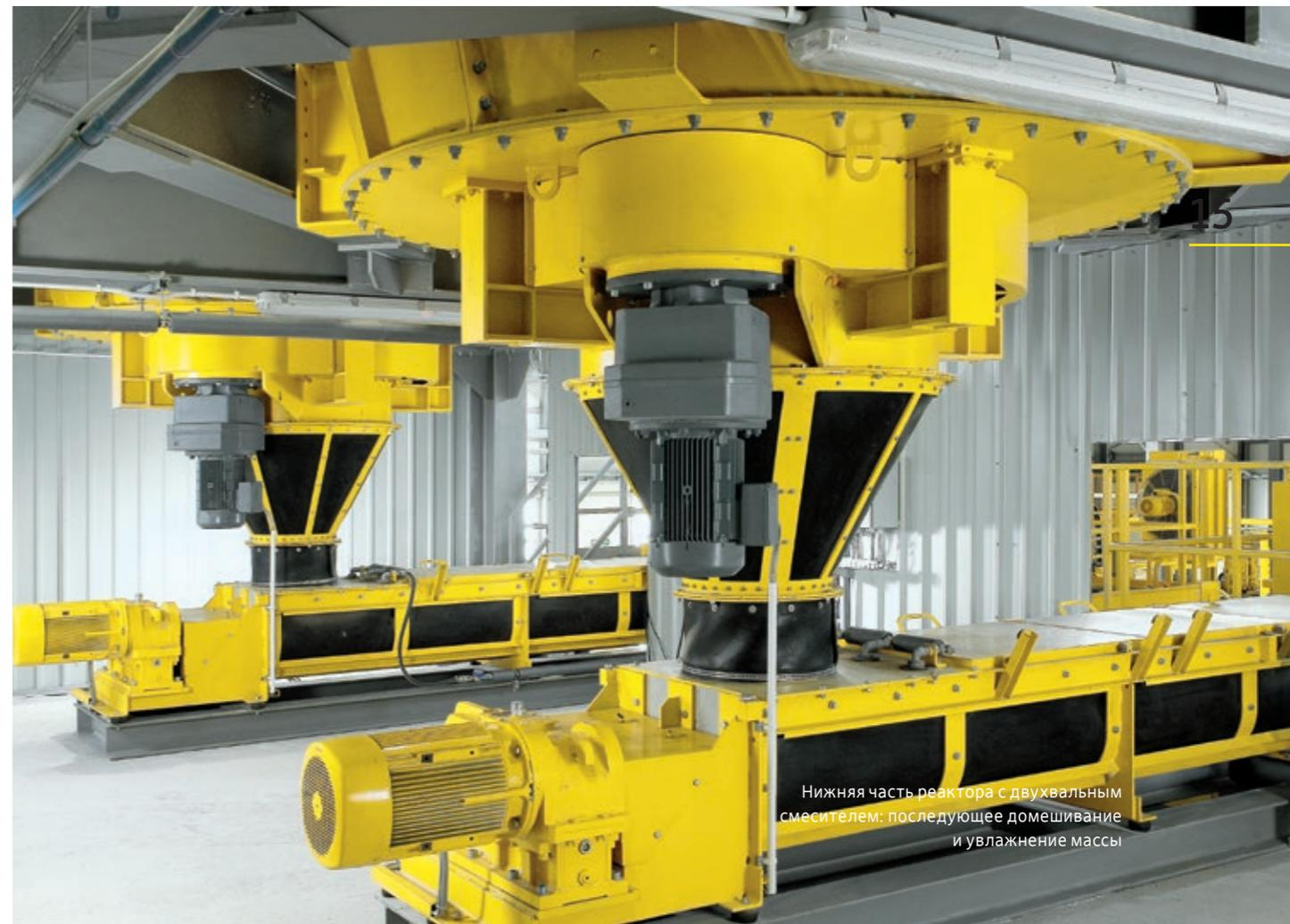
Нижняя часть реактора с двухвальным смесителем: последующее домешивание и увлажнение массы
